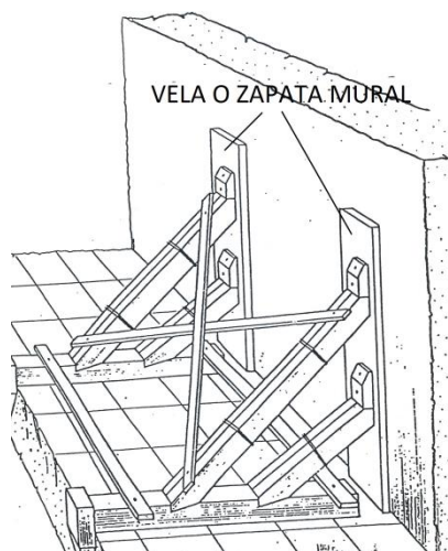
Figura 3.32. Vela en apuntalamiento de muro con tornapuntas.
