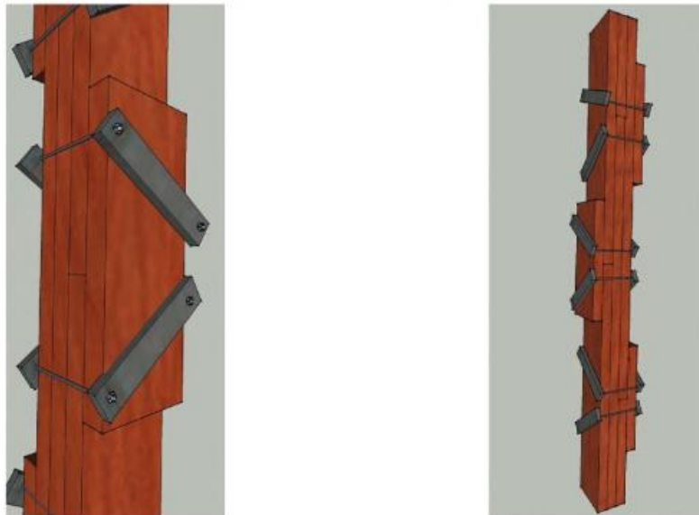
Figura 3.5. Detalle de unión de tablonos en pie derecho.
