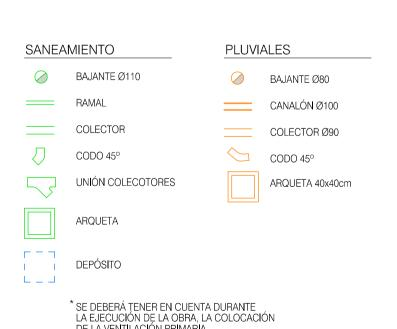
\* SE DEBERÁ TENER EN CUENTA DURANTE LA EJECUCIÓN DE LA OBRA, LA COLOCACIÓN DE LA VENTILACIÓN PRIMARIA
