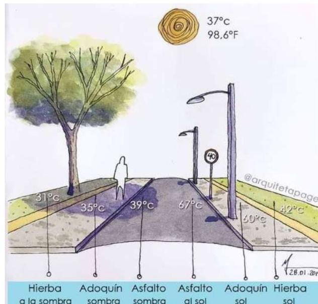
Figura 9. Cambios de temperatura mediante vegetación
