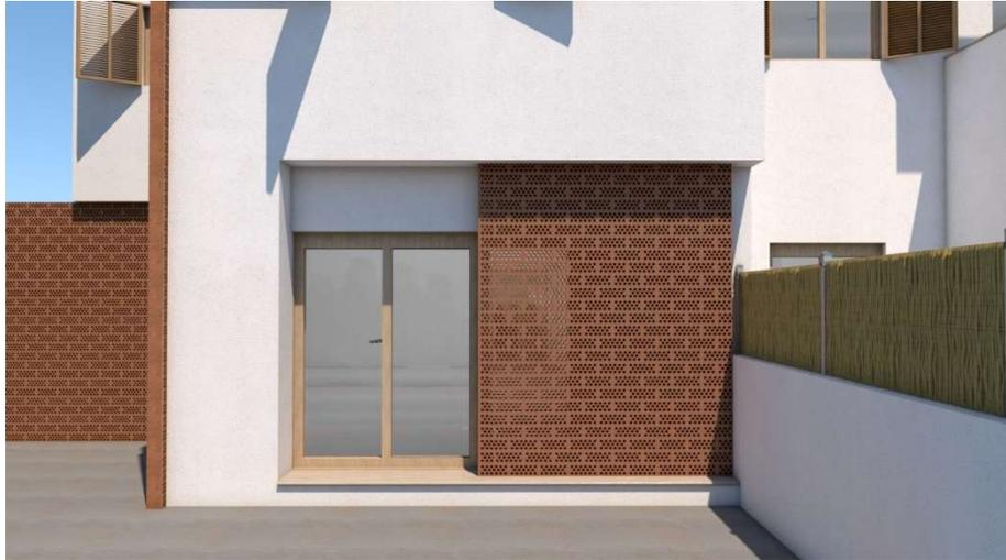
*Figura 16. Modelizado de celosías mediante ladrillos cerámicos*
