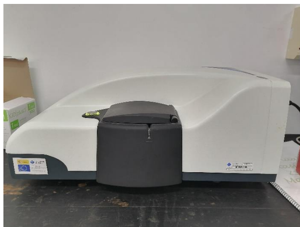
Figura 3.7. Equipo Zetasizer, Nano – ZS90 para la determinación del potencial zeta
