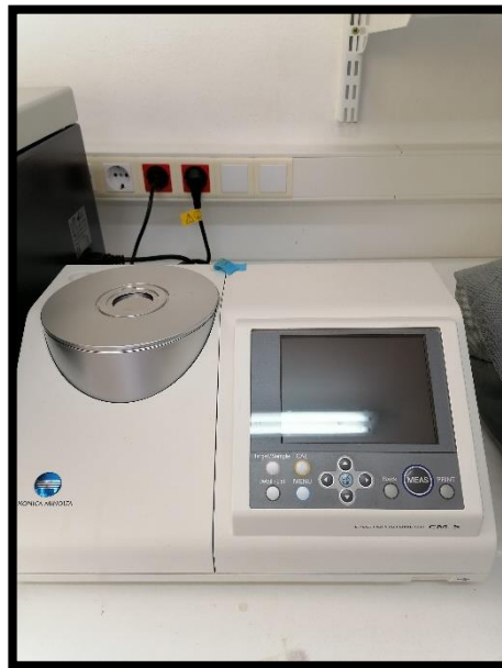
Figura 3.5. Espectrofotómetro CM5 Konica Minolta para el análisis de color
