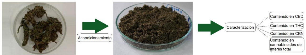
Figura 21. Procedimiento experimental utilizado para la caracterización del contenido de cannabinoides presentes en la muestra de cáñamo.
