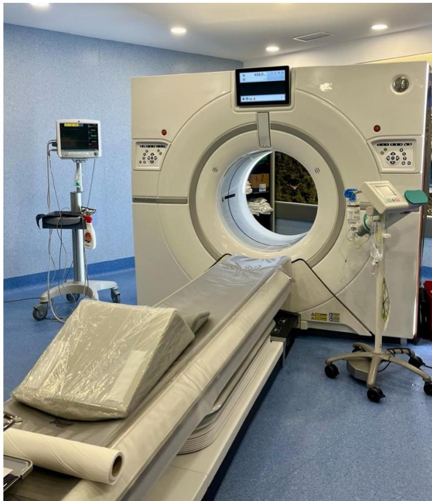
**Figura 18. TC espectral de única fuente de radiación con alterne rápido de keV con cobertura longitudinal de 8cm del HUSE.**
